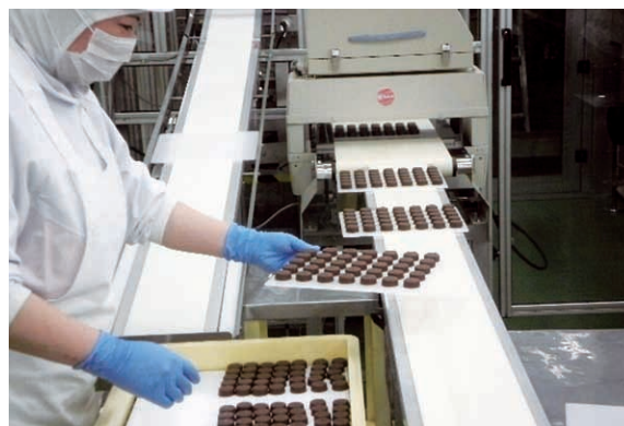
▲金属検出機と目視によるチェック
